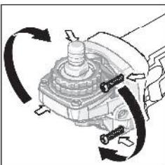
4 پیچ را کاملا ببرون بکشید. سر دستگاه را با احتیاط و بدون جدا کردن از بدنه به حالت جدید بچرخانید. 4 پیچ را دوباره ممکن کنید.
